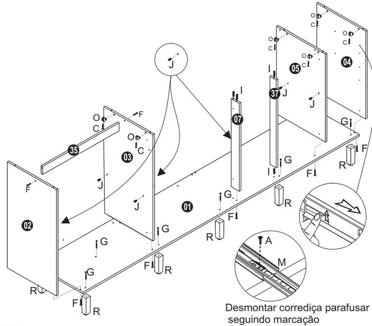
**3º** Unir módulo inferior ao módulo superior do armário, primeiro parafusar tampo 6 na lateral 3 em seguida coloque módulo superior sobre módulo inferior, parafusar de baixo para cima tampo 6 nas peças 12 e 13, use trapézio O e parafuso C para unir módulos.
