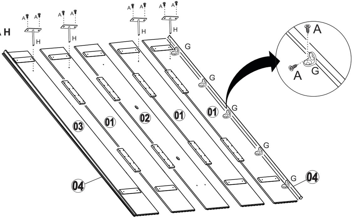
Fixar a peça 04, nos painéis 01 e 03 com o lado pintado para fora. Utilizado o acessório G com parafuso A
