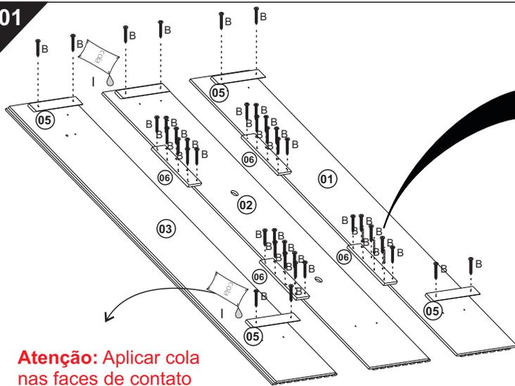
**Atenção:** Aplicar cola nas faces de contato entre fixadores 06 e painéis 01, 02 e 03.
